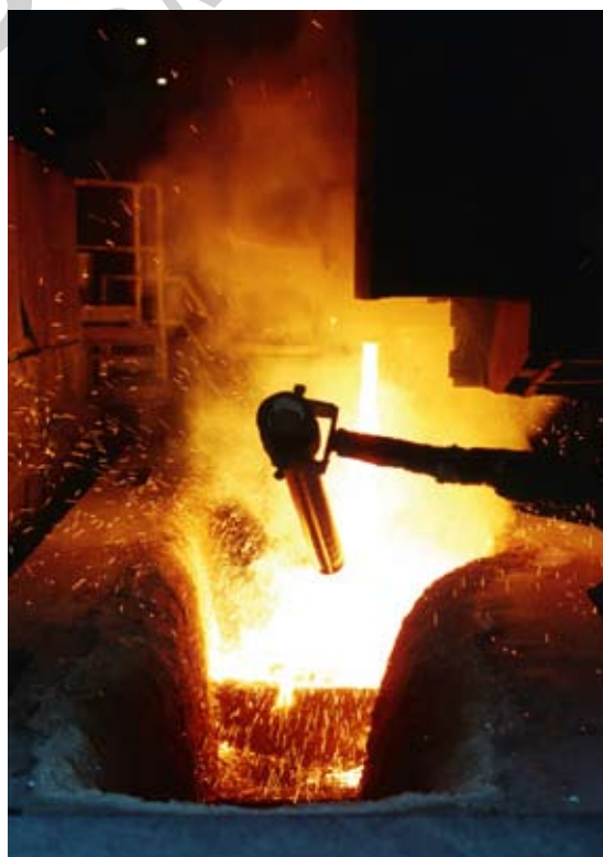
Angießen einer Sequenz beim Stranggießen von Stahl Start-up phase of continuous casting of steel
